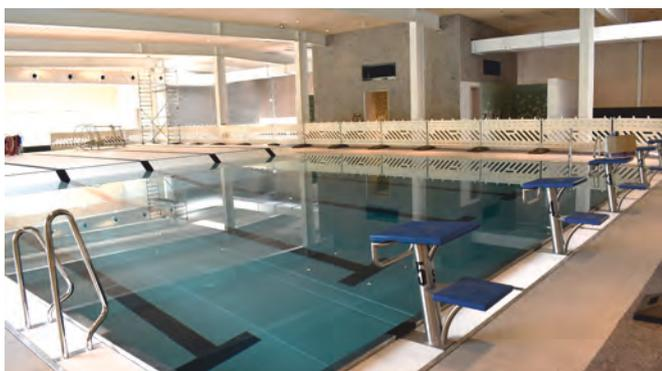
Das große Edelstahlbecken mit dem variabel einstellbaren Hubboden ist längst mit Wasser gefüllt.
